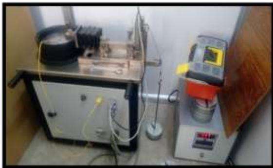
Figure-3. Pin-on-disk Wear test apparatus
