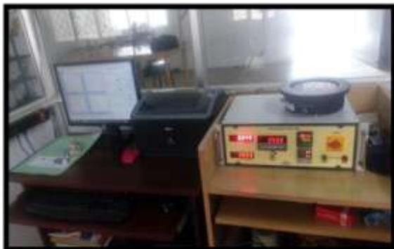
Figure-4. Pin-on-disk Wear test apparatus
