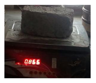
Figure.4.1.bulk density test
