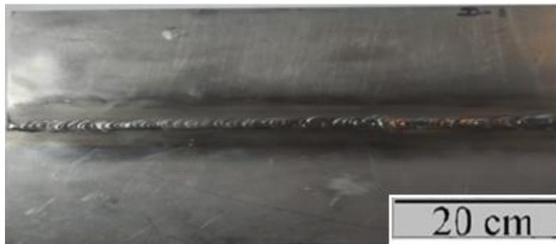
Fig 1 Gas tungsten arc welded IN718 alloy
