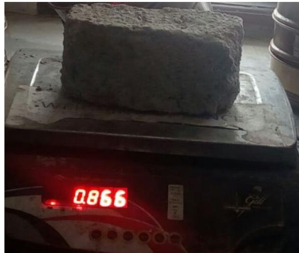
**Figure.4.1.bulk density test**
