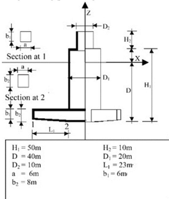
Fig. 2 Geometry of mini TLP
