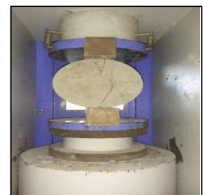
(d) Splitting tensile strength test
