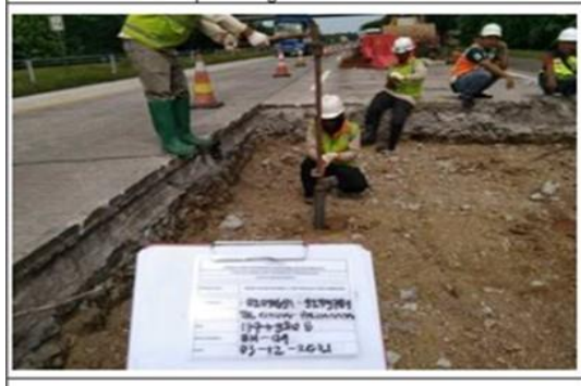
Fig. 11 UDS sampling using a hand auger
