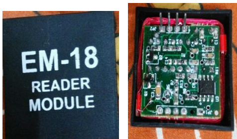
Fig-4: RFID reader module
