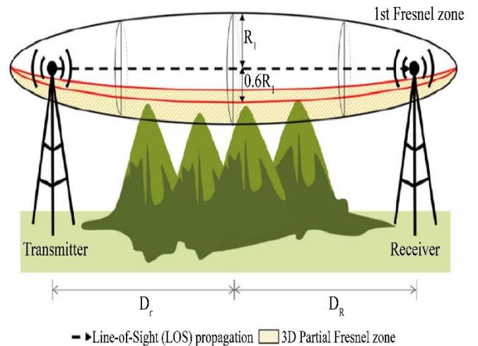
Fig. 5 Tx-Rx Line-Of-Sight with the 1<sup>st</sup> Fresnel zone
