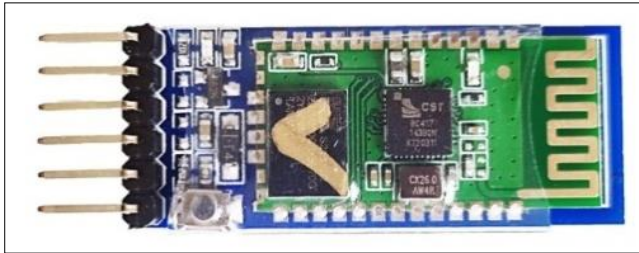
Fig. 8 Bluetooth module HC-05
