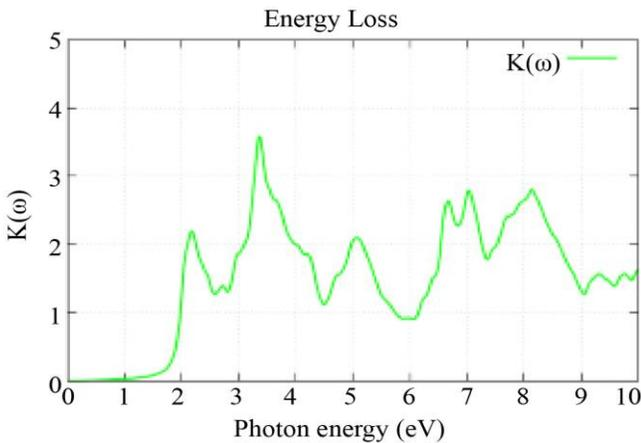
Fig. 9 Extinction coefficient
